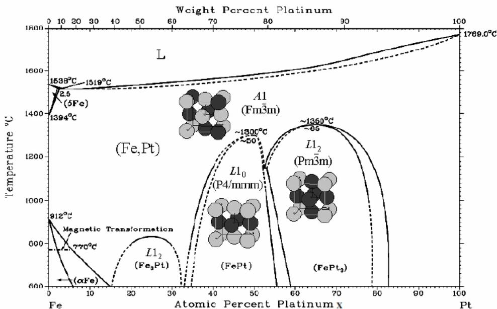
FIGURE 10 Eutetic Phase Diagram of Fe-Pt alloy (<http://www.himikatus.ru/art/phase-diagr1/Fe-Pt.php>)
