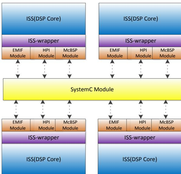
FIGURE 1 ISS-SystemC Framework.
